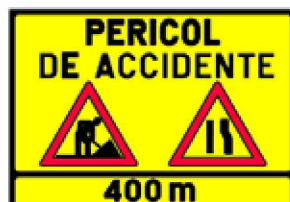
Presemnalizarea unui sector cu circulație alternantă
