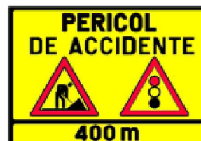
Presemnalizarea unui sector cu circulație alternantă
